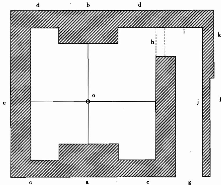
图 C.1 带有迷路的治疗机房及关注点示意图
